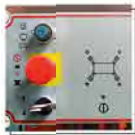
Внутрішня блокування аутригерів
