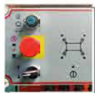
Внутрішня блокування аутригерів
